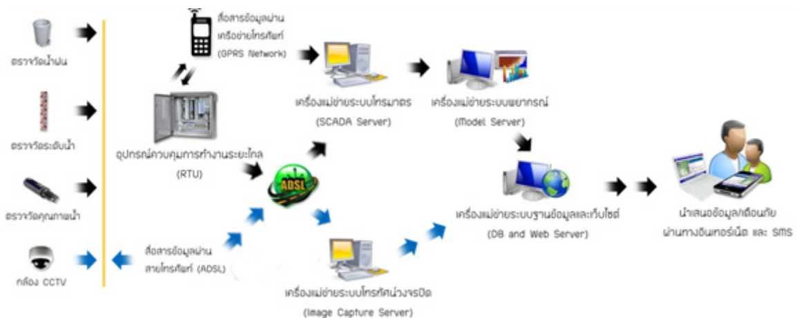
รูปที่ 3.1-1 องค์ประกอบและการเชื่อมโยงของระบบตรวจวัดข้อมูลทางไกลอัตโนมัติ
