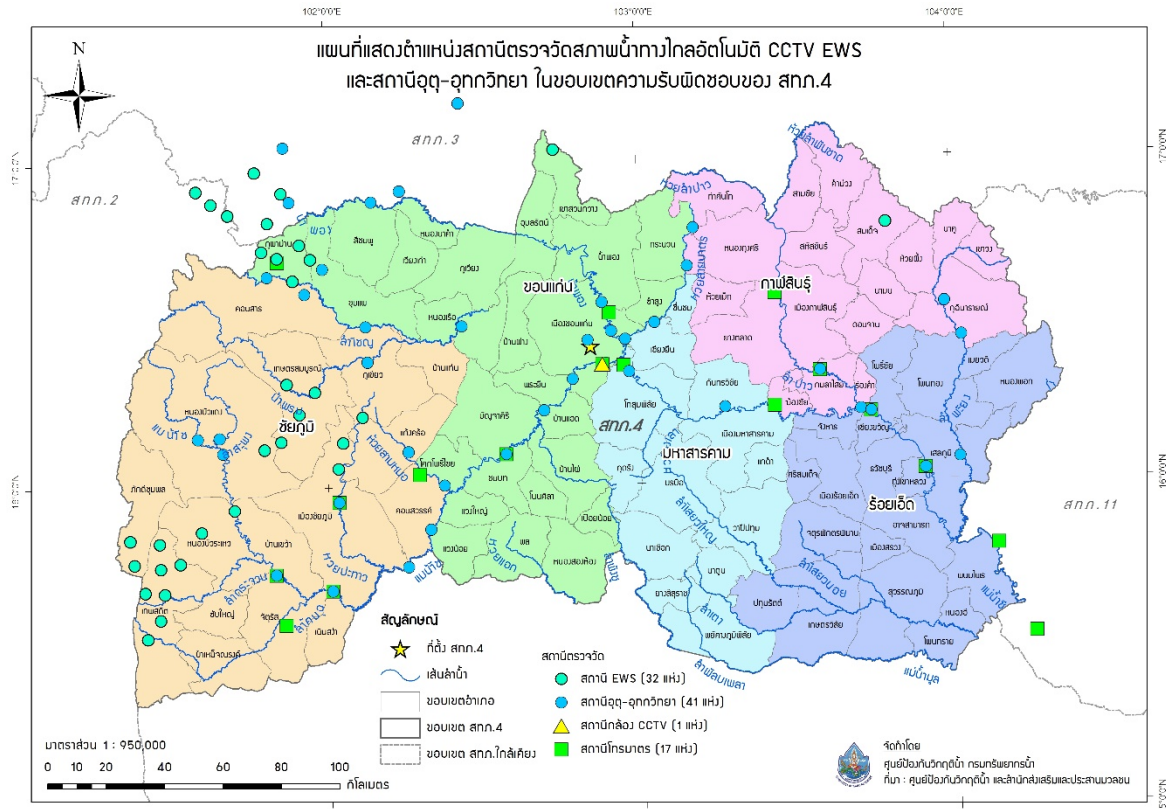
รูปที่ 4 ตำแหน่งสถานีตรวจวัดสภาพน้ำทางไกลอัตโนมัติ CCTV EWS และสถานีอุตุ-อุทกวิทยา ในเขตพื้นที่ความรับผิดชอบของสำนักงานทรัพยากรน้ำภาค 4
