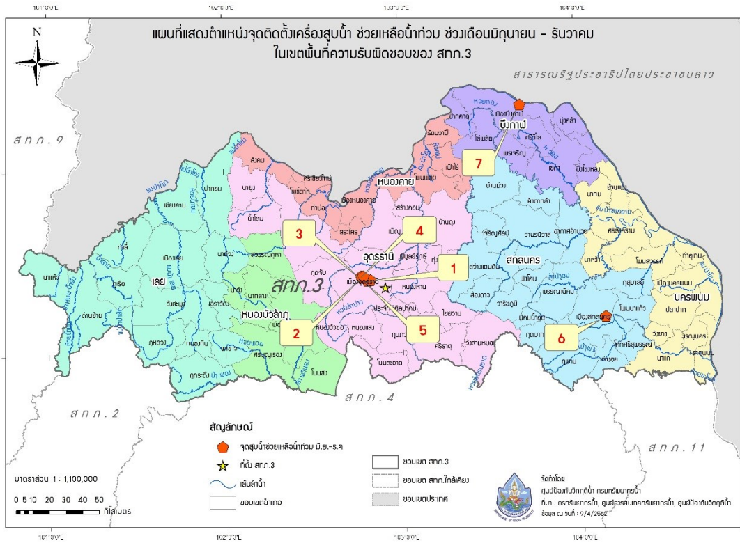
รูปที่ 1.7 ตำแหน่งจุดติดตั้งเครื่องสูบน้ำ ช่วยเหลือน้ำท่วมช่วงเดือนมิถุนายน – ธันวาคม ในเขตพื้นที่ความรับผิดชอบของสำนักงานทรัพยากรน้ำภาค 3
