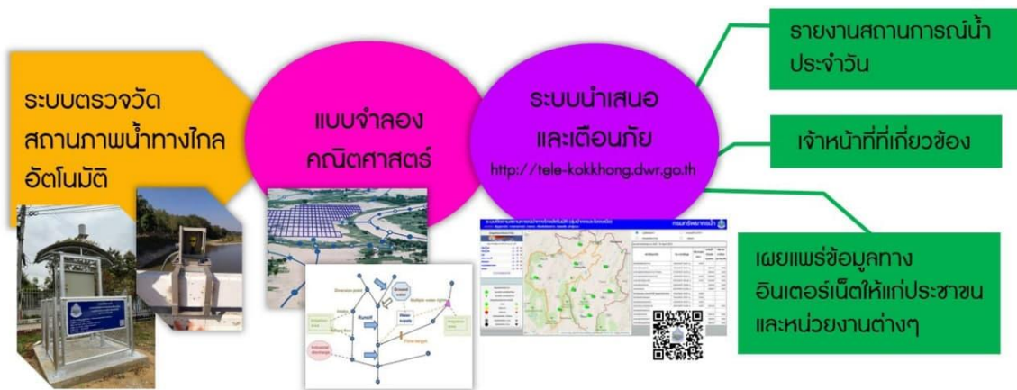
รูป 8 ระบบติดตามสถานการณ์น้ำทางไกลอัตโนมัติหรือระบบโทรมาตร
